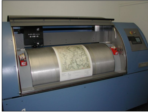
Figura 6.12: Escáner de tambor (fotografía: Stefan Kuehn)
