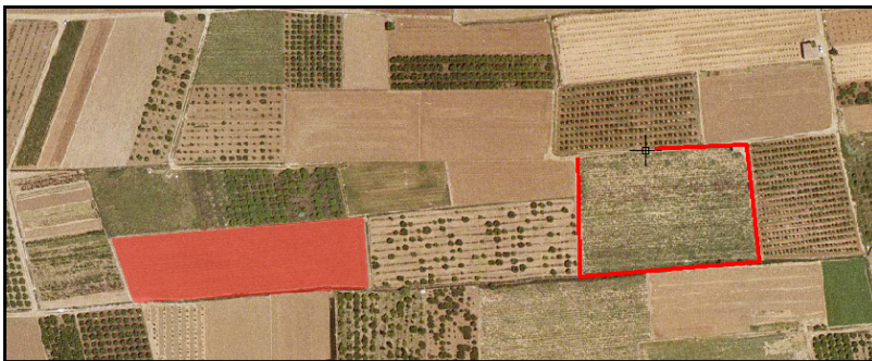
Figura 6.9: Digitalización en pantalla. En rojo, polígono ya digitalizado. Las líneas rojas indican un nuevo polígono, actualmente en edición
