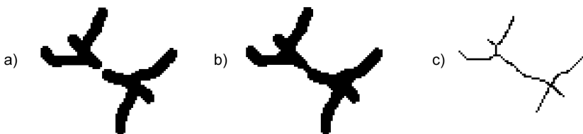
Figura 16.21: a) Imagen original con un objeto lineal desconectado. b) Objeto conectado tras la aplicación de una operación de cierre. c) Esqueleto del anterior objeto obtenido mediante la aplicación de operaciones morfológicas.
