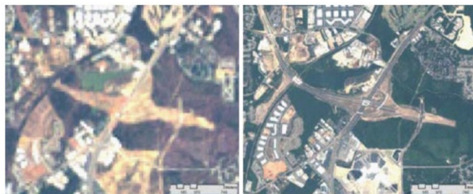
Figura 5- Immagini Landsat ETM + (a sinistra) e Quickbird (a destra) raffiguranti la medesima area, a dimostrazione della differenza di risoluzione spaziale tra i due sensori (Landsat ETM+ risoluzione multispettrale= 30 m; Quickbird risoluzione multispettrale =2.62 m). Nell'immagine Quickbird i singoli edifici e le caratteristiche stradali minori sono facilmente riconoscibili (Fonte: S. Khorram, Frank H. Koch, C. F. van der Wiele, Stacy A. C. Nelson- Remote Sensing, 2012 libro formato PDF).
