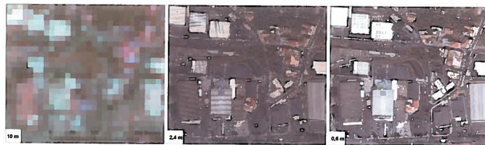
Figura 2.10. Confronto fra tre immagini di una stessa zona ripresa a risoluzione spaziale diversa
