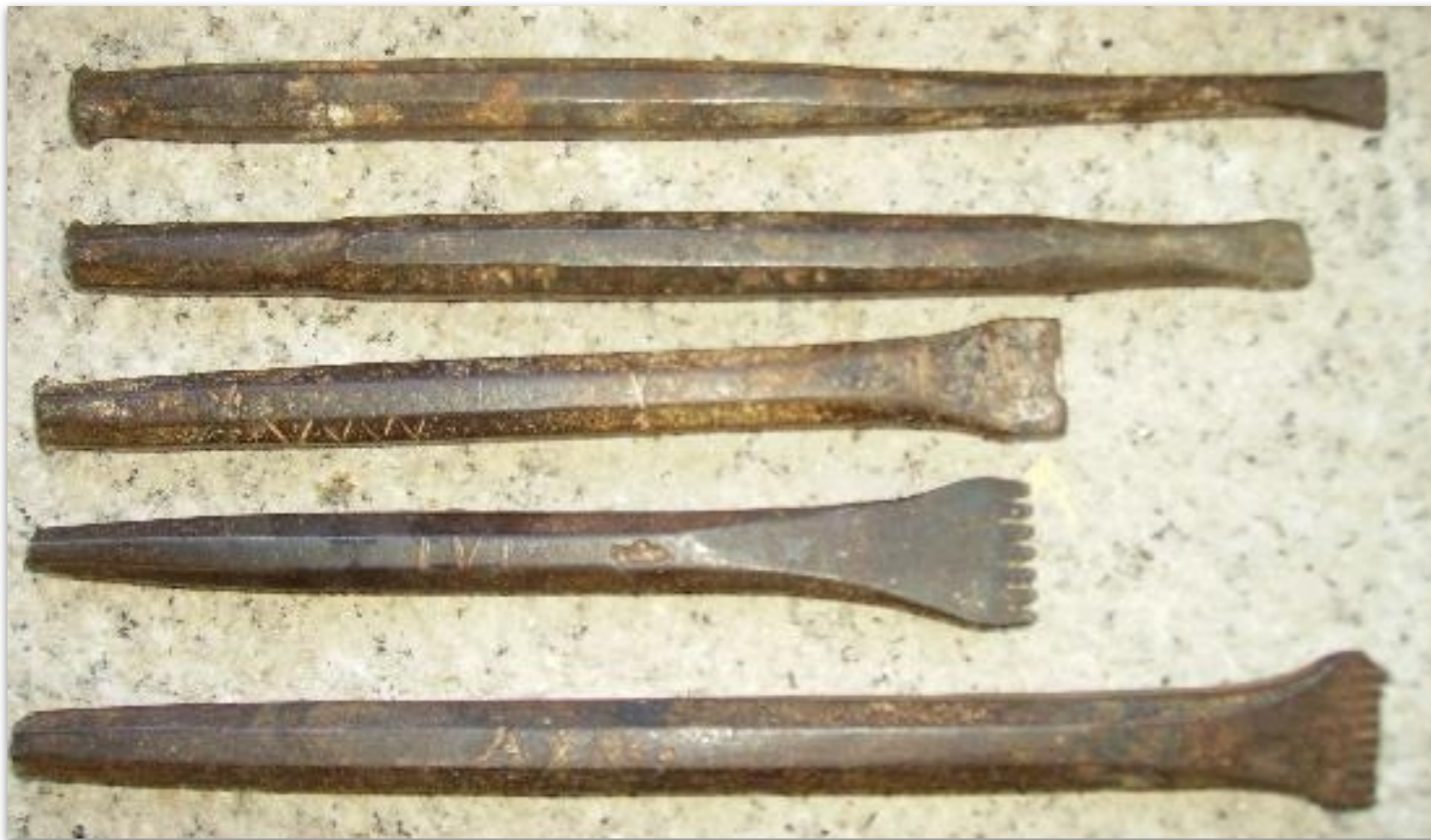
Gli strumenti dello scalpellino: scalpelli, sgorbie e gradine
