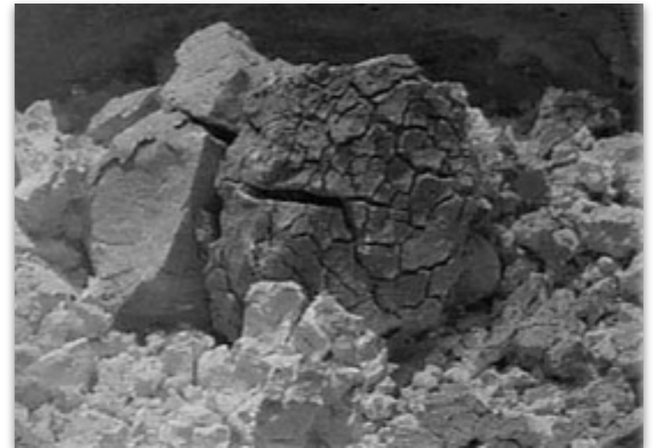
La calce viva (ossido di calcio) all'uscita dalla calcara
