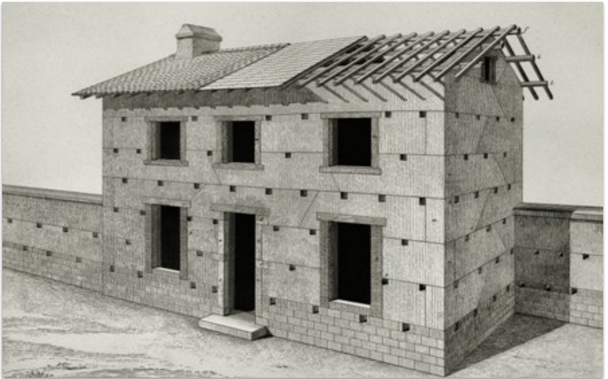
Casa in pisé , dal Traité sur la construction des manufactures et maison de campagne di Jean-Baptiste Rondelet (1802-17)
