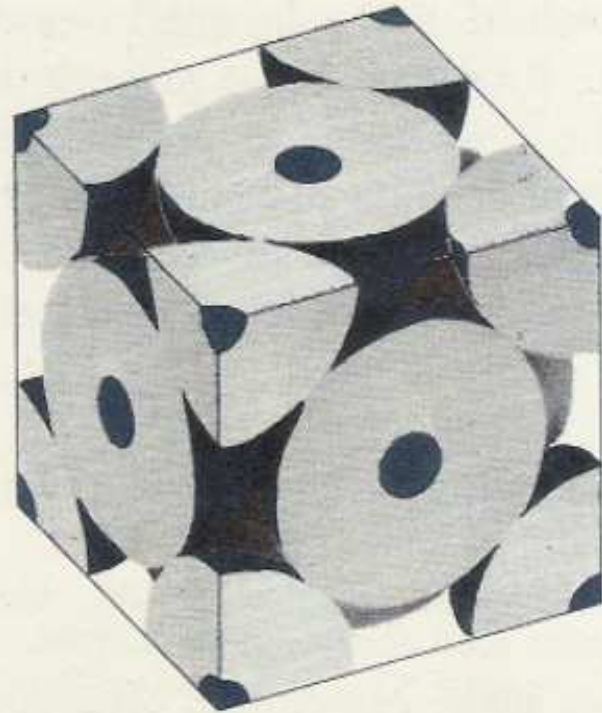
Fig.19 Sistema cubico a facce centrate (fcc). a) Modello a sfere rigide. Gli atomi si trovano ai vertici e al centro delle facce della cella cubica. Vi sono 4 sfere per cella cubica ( 8/8 ai vertici e 6/2 al centro delle facce). b) Correlazione fra le Figg. 19 e 18.
